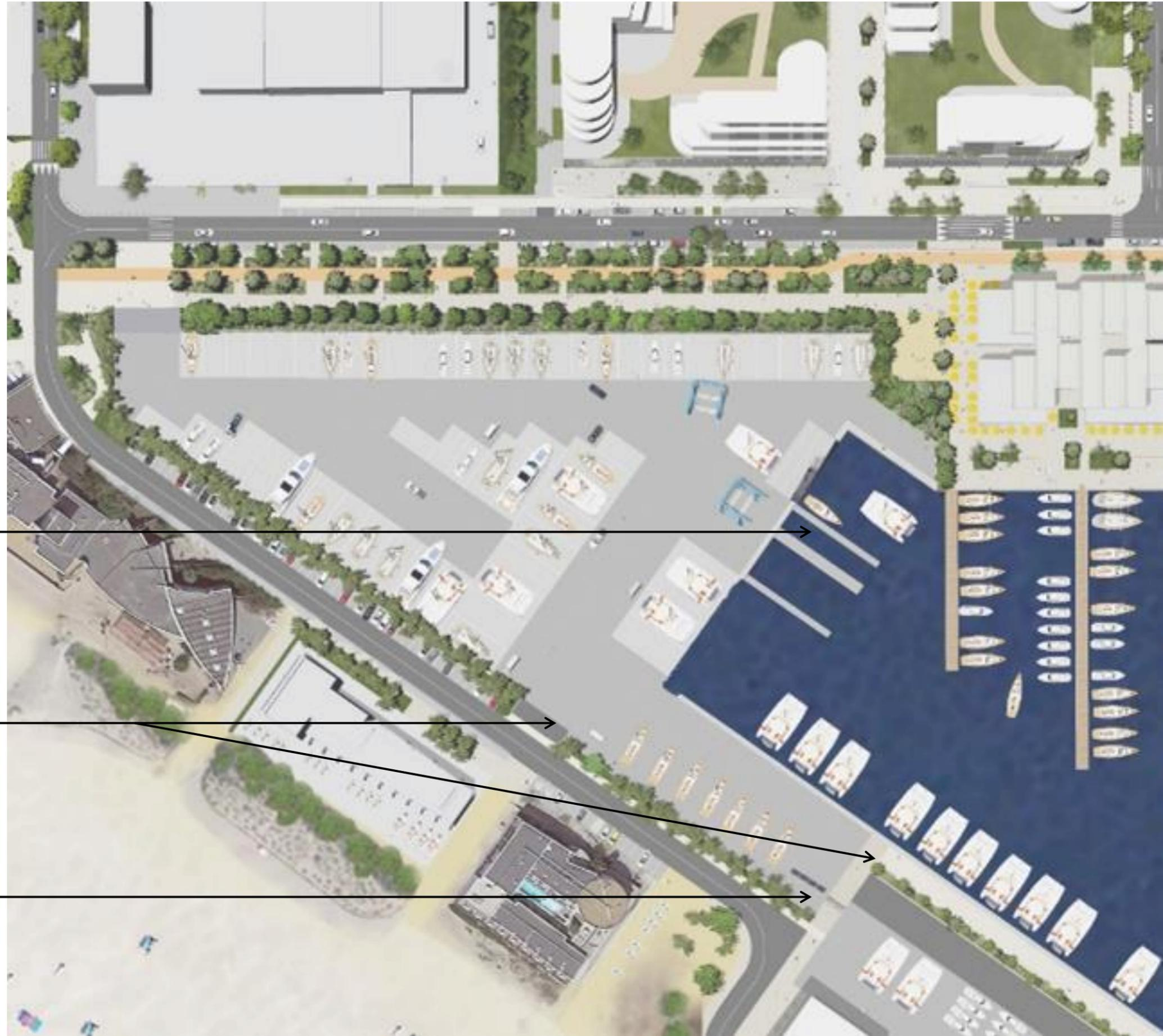
Remplacement et élargissement des darses (5m et 6,5m)+ réfection cale de mise à l'eau
